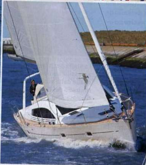
Sopra, il Pilot Saloon 47 in andatura di traverso. I parametri progettuali definiscono uno scafo stabile sia di forma sia di peso e dotato di un passo sull'onda morbido. A destra, in navigazione di bolina, mette in evidenza la prua con un dritto quasi verticale ed entrate sottili.
